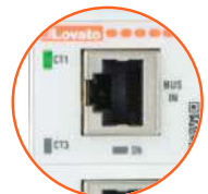
LED-Anzeige für korrekte Selbstkonfiguration und Kopplung
