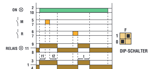
Verzögertes Abfallen des Relais
